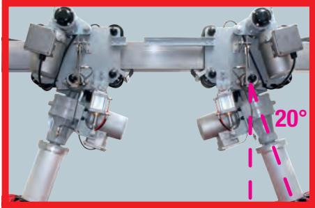
Sidebørstene kan tiltes 20°, som medfører en effektiv og konturførendevask. Automatisk justering av børstetrykk.
